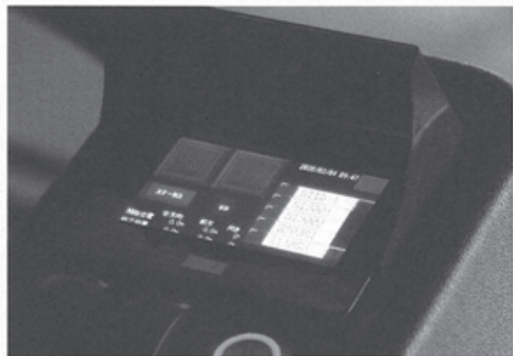
上/本体の上に装着されたGNSS受信機 左/本体にタッチパネルがあり、そこから操作を行う
